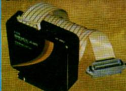
Conecta el Spectrum a cualquier impresora tipo paralelo (Centronics) a Serie (RS232C). Requiere cualquier pantalla visible de alta resolución y color. No se necesita ningún programa adicional para su funcionamiento.
