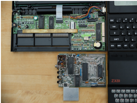
Oben die Platine des Z88, unten die eines ZX81.
