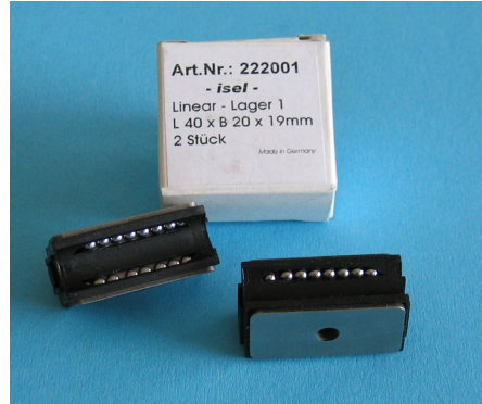
Linearlager für die X-Achse (für den Frästisch L = 80 mm)
