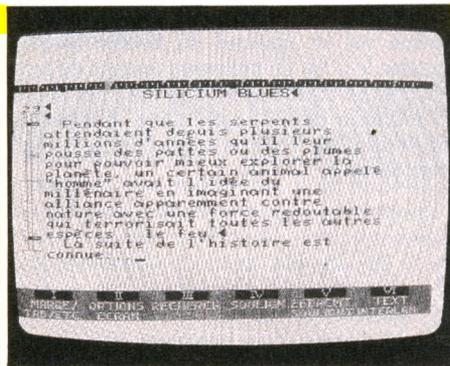
L'Adam est doté d'un clavier mécanique séparé de l'unité centrale : bien pratique pour travailler avec l'ordinateur sur le bureau. Le traitement de texte Smartwriter est intégré en mémoire morte : immédiatement disponible à la mise sous tension de l'appareil. On peut disposer du jeu de caractères français avec les lettres accentuées.
