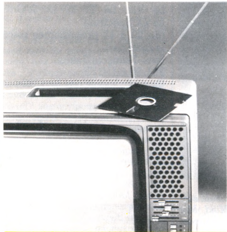
Un programme oublié sur le coin d'un téléviseur, et le voilà détruit par champ magnétique.
