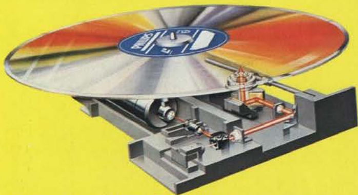
L'interno di un lettore al laser: il fascio rosso indica il percorso del raggio laser.
