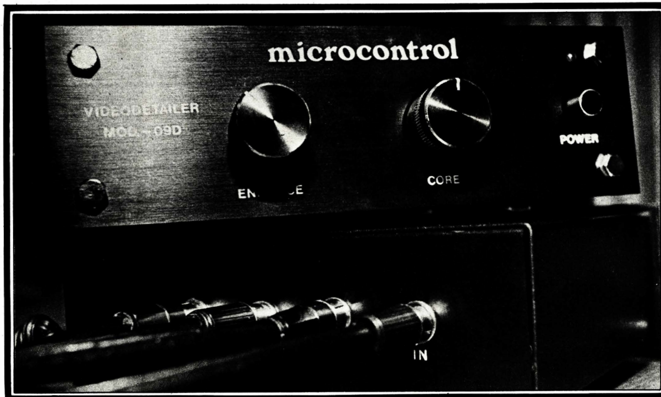
Videodetailer, acessório usado na cópia de fitas, permite melhorar a qualidade da imagem reproduzida.
