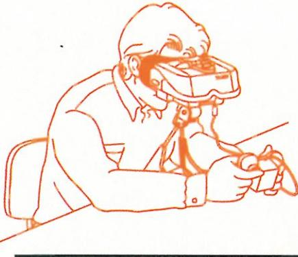
Parte fundamental de la máquina donde se colocan las dos pantallas que permiten percibir el efecto tridimensional. En cada una de éstas se produce una imagen sensiblemente diferente de la otra. Si probáis a jugar mirando sólo por una pantalla, veréis la enorme diferencia de sensaciones.
