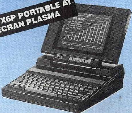
HDM X6P, Portable AT, écran plasma : PROMO 80286 - 12 MHz, 512 K RAM, écran plasma 640 x 400 Sortie CGA et MDA, lecteur 1.44 Mb ou 720 K 3" 1/2, disque dur 20 Mb 3" 1/2, port parallèle et RS 232 C
