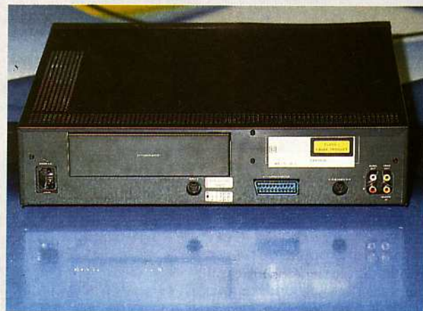
Le CD-I 205 aura décidément fière allure au milieu du salon familial. Ci-dessus, à l'arrière de l'appareil, où figurent les connexions audio et vidéo (en France, une simple Péritel suffit), on trouve la trappe qui permettra d'inclure l'extension de Full Motion Video.
