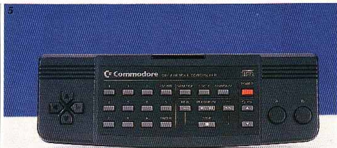
5. Le joystick infrarouge a plusieurs fonctions. Le jeu (flèches de déplacement et bouton de tir) et le transfert du CDTV en CD audio.
