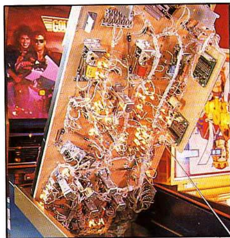
L'envers du décor : un entrelas confus d'éléments électromécaniques, de fils et d'ampoules.
