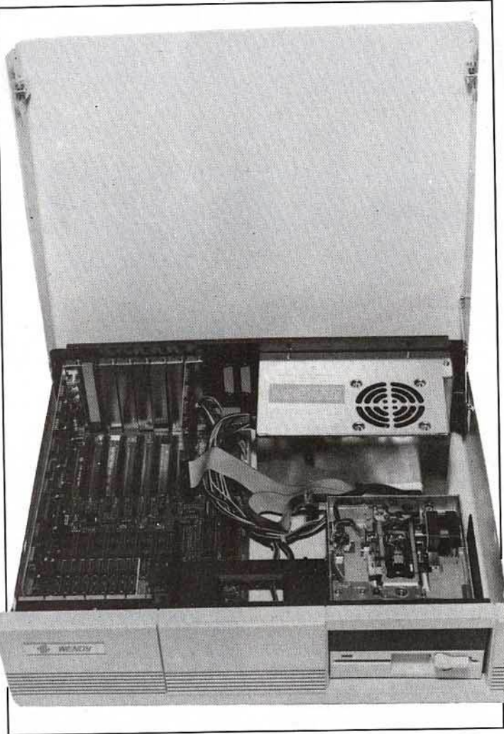
Une exemplaire clarté d'implantation des différents éléments, au service d'une accessibilité maximale. Au fond à droite, l'alimentation surdimensionnée, ventilée et dûment blindée.
