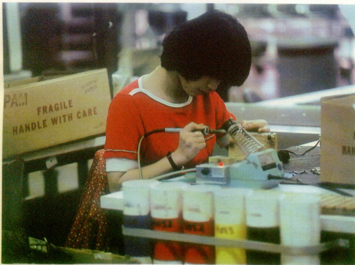
Chaque opérateur a pour tâche de monter deux ou trois pièces et - en plus - de vérifier le travail de ses collègues. Chaque ouvrier est l'inspecteur des autres. Une technique classique du travail à la chaîne.
