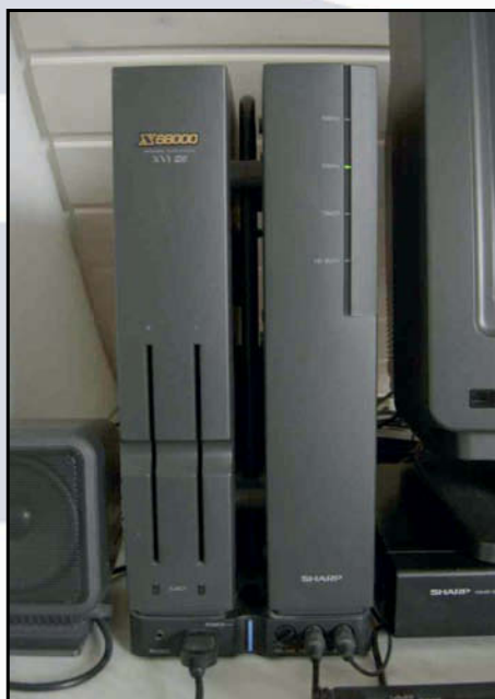
Uno sguardo ravvicinato al case dell' X68000: notate la maniglia retrattile in mezzo alle due unità.
