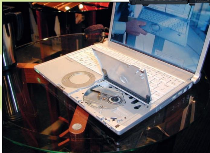
L'originale collocazione dell'unità ottica del CF-77 permette un netto risparmio di spazio e una più facile integrazione, oltre che l'eliminazione di qualsiasi parte in movimento soggetta a possibili rotture.
