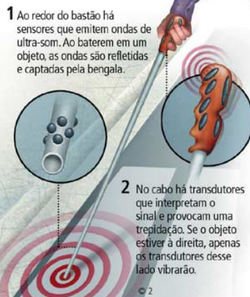
1 Ao redor do bastão há sensores que emitem ondas de ultra-som. Ao baterem em um objeto, as ondas são refletidas e captadas pela bengala.
