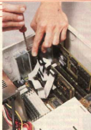
Encaixe a placa IO no slot e aparafuse as duas chapas na parede do fundo
