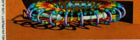
Microondas num bloco de cobre: a flecha branca representa o campo elétrico; as coloridas, os campos magnéticos e suas diferentes forças
