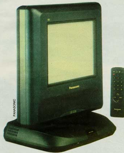
Apesar de plana, a tela do Flat Vision da Panasonic não é feita de cristal líquido: usa um novo sistema no velho tubo de raios catódicos
