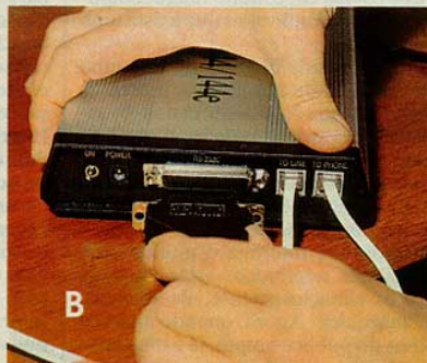
Para instalar o modem externo, comece conectando os dois fios que ligam o modem à linha telefônica (foto A). Os encaixes pequenos desses fios são do tipo americano, mas para ligá-los aos fios de telefone que vêm da parede existem adaptadores para o padrão nacional. Depois, é só usar um cabo de conexão e ligá-lo primeiro ao modem (foto B) e em seguida ao micro (foto C). Feito isso, basta ligar o modem à tomada elétrica e configurar o micro
