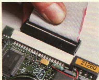
A margem colorida dos cabos deve ligar-se aos pinos 1 e 2 nos conectores dos drives e placas IO
