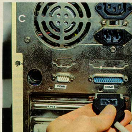
Para instalar o modem externo, comece conectando os dois fios que ligam o modem à linha telefônica (foto A). Os encaixes pequenos desses fios são do tipo americano, mas para ligá-los aos fios de telefone que vêm da parede existem adaptadores para o padrão nacional. Depois, é só usar um cabo de conexão e ligá-lo primeiro ao modem (foto B) e em seguida ao micro (foto C). Feito isso, basta ligar o modem à tomada elétrica e configurar o micro
