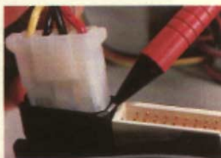
Os cabos de força para os drives também têm chanfros de encaixe
