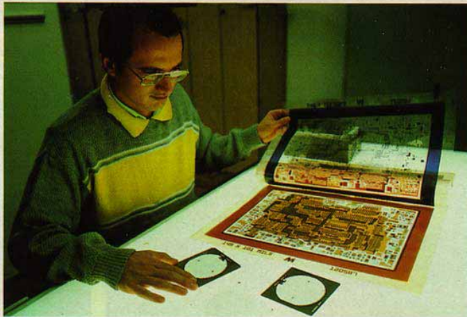
Reduzidos em tamanho, os circuitos são feitos em máscaras de vidro...
