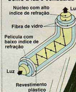
Cabos óticos: luz codificada nas fibras multiplica capacidade de enviar chamadas
