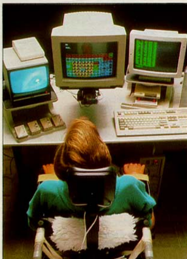
A câmera embaixo do monitor central capta a imagem do olho em movimento. Pode-se escrever ou acionar comandos sem usar as mãos
