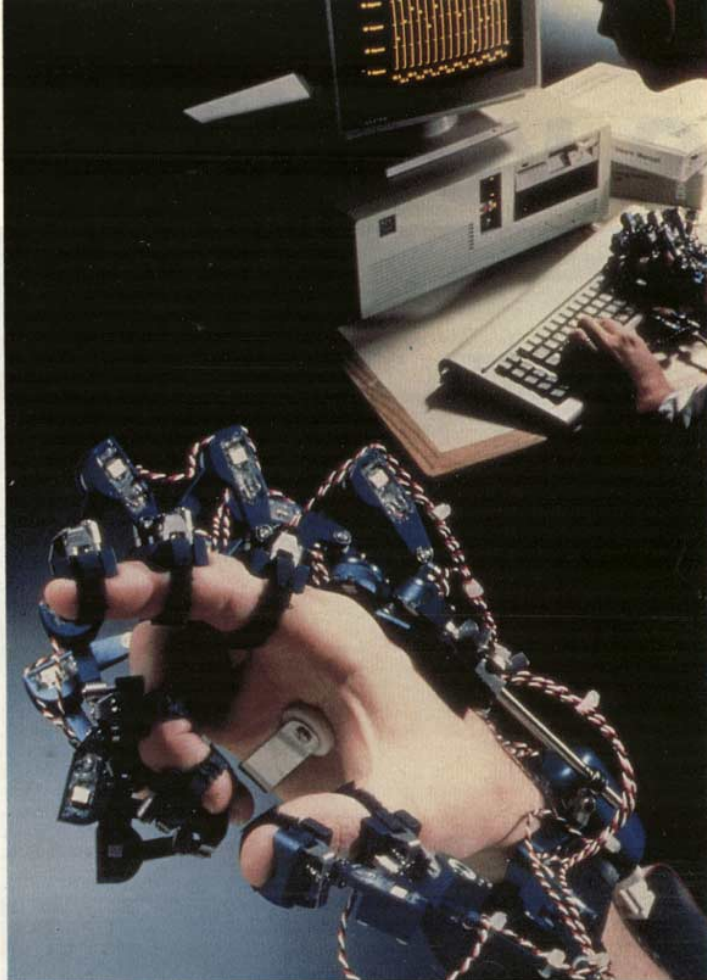
Sensores de movimento acoplados às mãos ou presos a luvas especiais indicam o que fazer ao desenho tridimensional, criado pelo computador nas telas de uma máscara
