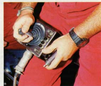
Técnico a bordo do navio Poseidon guia o trabalho dos robôs no fundo do mar (no alto). Os visores mostram imagens de TV e de sonar. Um bastão de videogame é usado para direcionar os aparelhos (acima). Scorpio flexiona os músculos do braço, que pode carregar 227 quilos de equipamentos (esquerda)
