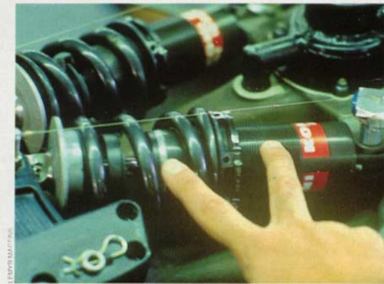
O engenheiro Guazzelli explica o equipamento: abaixo, à esquerda, o computador que gerencia o motor; à direita, mola e amortecedor com potenciômetro
