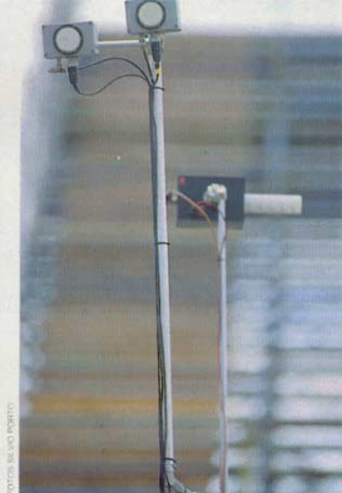
Acima, à esquerda, o kit eletrônico na lateral do carro: computador, bateria e o lugar do rádio para transmissão. As duas antenas (acima) captam a frente do boxe o sinal das antenas do carro (ao lado)
