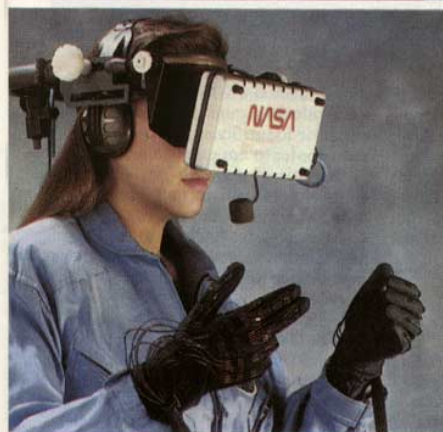
Sensores de movimento acoplados às mãos ou presos a luvas especiais indicam o que fazer ao desenho tridimensional, criado pelo computador nas telas de uma máscara
