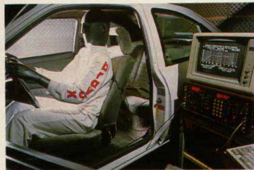
A cabeça do boneco, com microfone na orelha, recebe o som como um ouvido humano. O analisador computadorizado elabora um gráfico das frequências que ele ouviu
