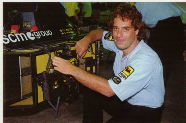
O engenheiro Guazzelli explica o equipamento: abaixo, à esquerda, o computador que gerencia o motor; à direita, mola e amortecedor com potenciômetro
