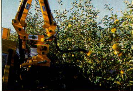
O robô Magali caminha entre macieiras, colhendo só as frutas maduras que ele vê com o auxílio de filtros de luz
