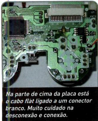
Na parte de cima da placa está o cabo flat ligado a um conector branco. Muito cuidado na desconexão e conexão.
