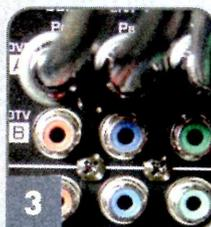
4) Ligue as caixas em seus respectivos conectores. Não inverta a polaridade e preste atenção na identificação dos conectores no receiver. Repare na foto. Os conectores de áudio são os pinos maiores.
