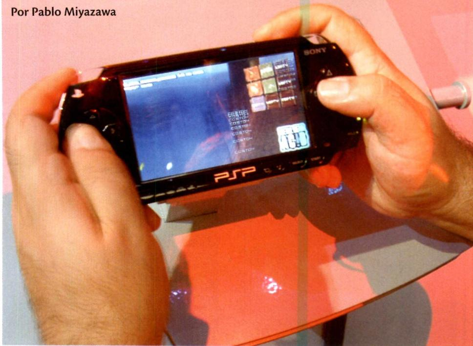
um retângulo) e um para controlar o volume. Há uma entrada USB na parte superior. Os games (ou filmes) virão na forma de mini-discos de 1.8 GB. Eles são encaixados na parte de baixo do console. A parte traseira possui uma janela transparente, que permite ao jogador ver o disco em funcionamento.
