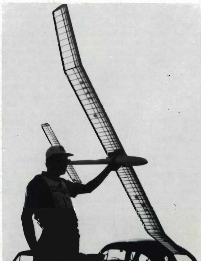
Aliante radiocomandato, notare la struttura delle ali.
