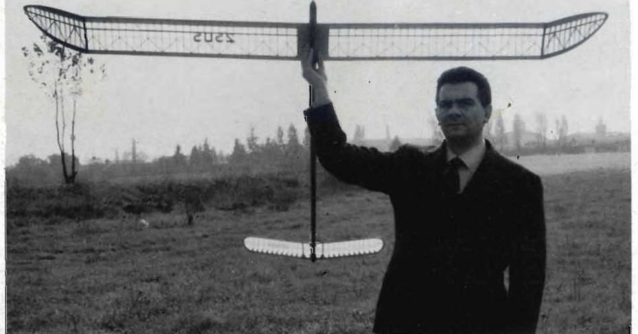
Modello veleggiatore, notare la struttura dell'ala.
