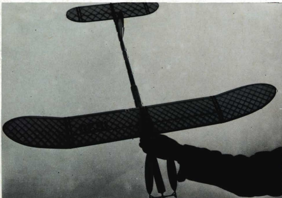
Modello Coupe d'Hiver. Notare la bellissima struttura geodetica dell'ala. La fusoliera è del tipo a tubo.
