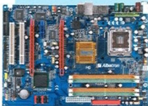
青雲 PX945P：支援 Intel Pentium D 8xx 系列處理器 / 支援雙通道 DDR2 667MHz / 4 組 SATA2 連接埠 / mPOWER2 採自動偵測超頻 / 雙 PCI-Express x 16、支援 SLI
