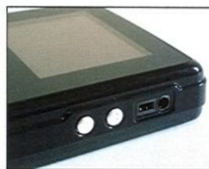
右側機身則配置音量調整鈕與線控器插槽。
