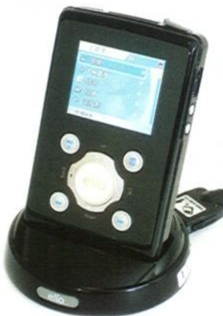
elio PJ 採用鋰電池，可放入底座充電。
