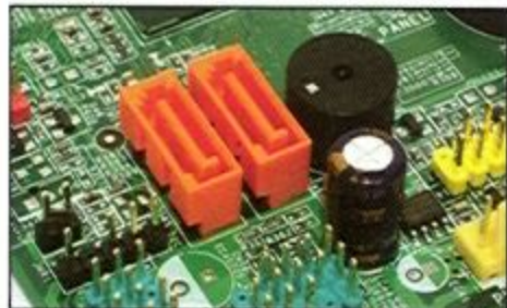
橘色的部份是 SATA 連接埠，並在塑膠四邊加強了連接的穩固性。
