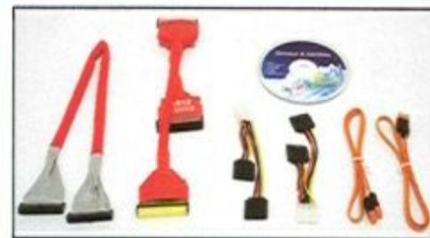
這是主機板所附的線材配件，除了有 FDD/IDE 排線外，另外還有 SATA 連接線與電源線。
