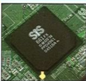
主機板使用 SiS661FX 晶片，支援最新 800MHz 前端匯流排時脈，提供高達 6.4GB/s 的資料傳輸頻寬。
