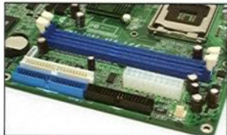
提供 2 條 DDR 記憶體插槽與 2 個 IDE 連接埠。
