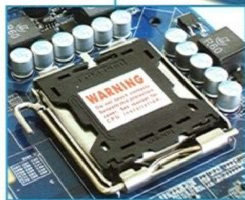
Socket 775 規格的處理器插座。
