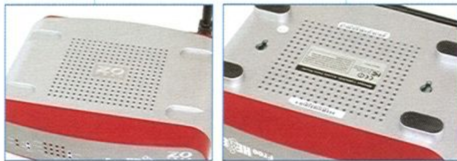
機體上下方皆有散熱孔設計。
