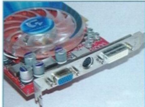
GV-R80P256D提供15Pin D-Sub、DVI以及S端子視訊輸出接頭。
