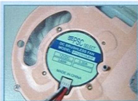
散熱風扇採12VDC、3.6WPSC風扇。
