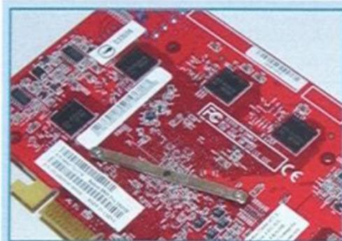
顯示卡背面有四顆記憶體，且外加一個固定散熱系統的金屬桿。
