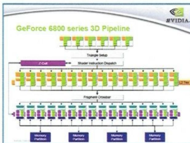
6800 Ultra 內部共有 2.22 億電晶體，擁有 16 條圖元流水線，支援「16X1 和 32X0 no Z Value」兩種渲染方式，採用 NVIDIA 最新的 CineFX 3.0 圖形引擎，完全支援微軟 DirectX 9.0 中的 Shader Model 3.0 (包括遊戲最需要的 VertexShader 3.0 以及 PixelShader 3.0)，以及 OpenGL 1.5。
