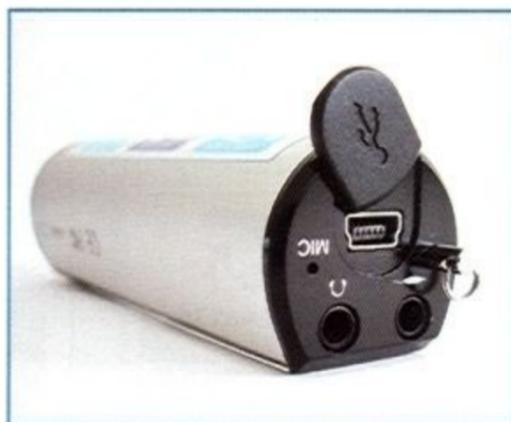
DS701 採用傳輸速度較慢的 USB 1.1 介面，不過卻擁有麥克風及 LINE-IN 輸入錄音功能。
