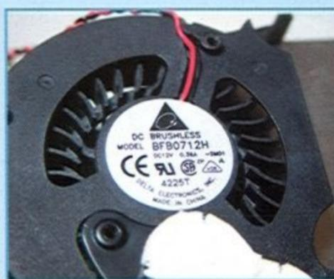
散熱風扇採 12VDC、3.6W 風扇。
