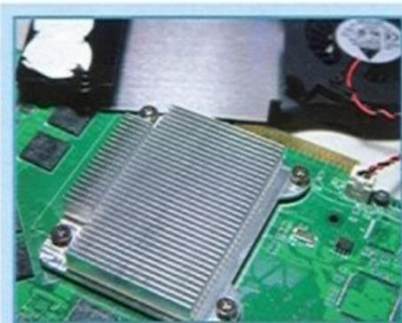
大型散熱片拆除後，顯示晶片上還有一個
