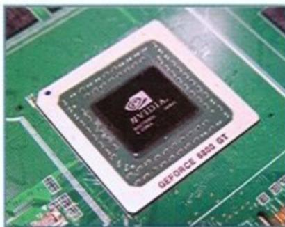
GeForce 6800 Ultra 晶片採用 0.13  $\mu$ m 製程、晶片本身共有 1309 Pin (腳位)，顯示晶片預設的時脈在 400MHz，顯示記憶體則是 1100MHz。
