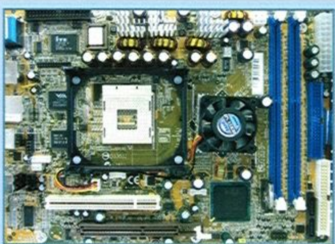
SB61G2 XP採用Intel 865G晶片組的主機板 支援 Intel 最新的Prescott中央處理器是其一大特色。
