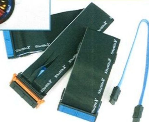
這是SB61G2 XPC附屬的磁碟機排線，長度都設計的剛剛好，完全為準系統量身設計。
