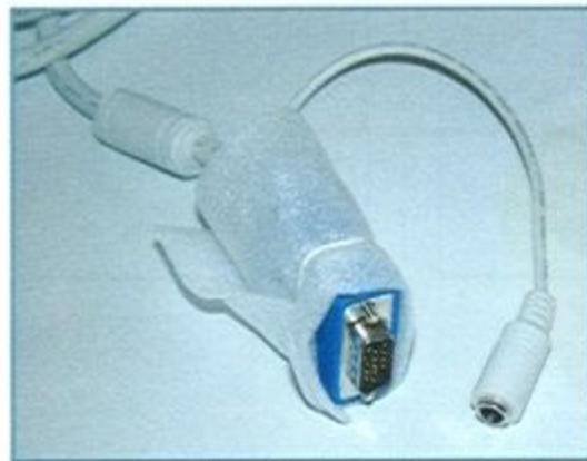
利用一條線材將 D-Sub 與電源線接在一起，有效減少線材的雜亂感，並增加安裝的便利性。
