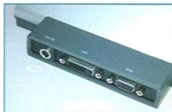
背後提供電源轉換器的DC輸入介面和RGB信號輸入介面。
