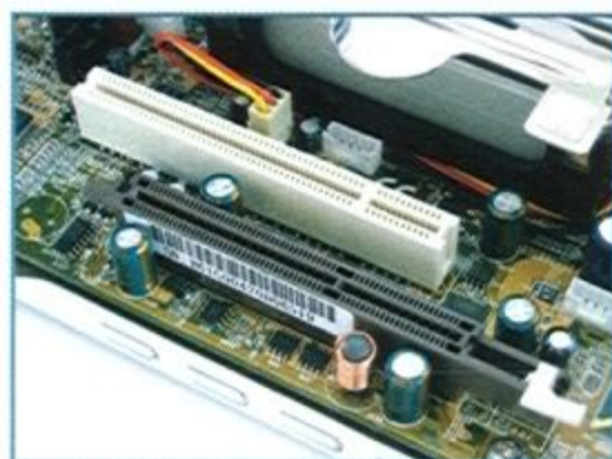
主機板上提供32位元的PCI與8X規格的AGP擴充槽。
