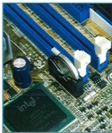
考量主機板的空間有限，將水銀電池改為直立式安裝，相當用心。
