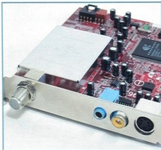
MS-8606 除可接受有線電視 Cable 訊號的連接，也提供 AV 端子與 S 端子的影音輸入。
