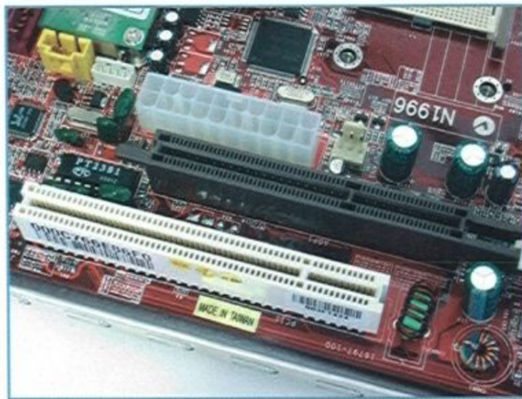
考慮到擴充需求，主機板亦提供一條 AGP 插槽（上）與 PCI 插槽（下）。
