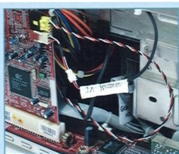
這是 MS-8606 視訊卡與 MEGA 865 準系統連接的情形，黃色接頭是連接到主機板的音效插孔上，白色接頭則與遙控器的控制線相連。
