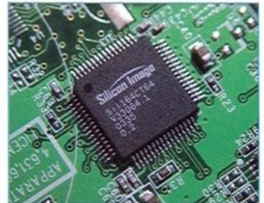
Silicon Image 的 Si1164CT64 DVI 轉碼晶片來控制 DVI-I 轉碼的功能
