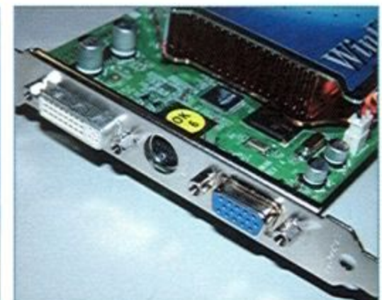
提供15Pin D-Sub、DVI-I與S端子輸出
