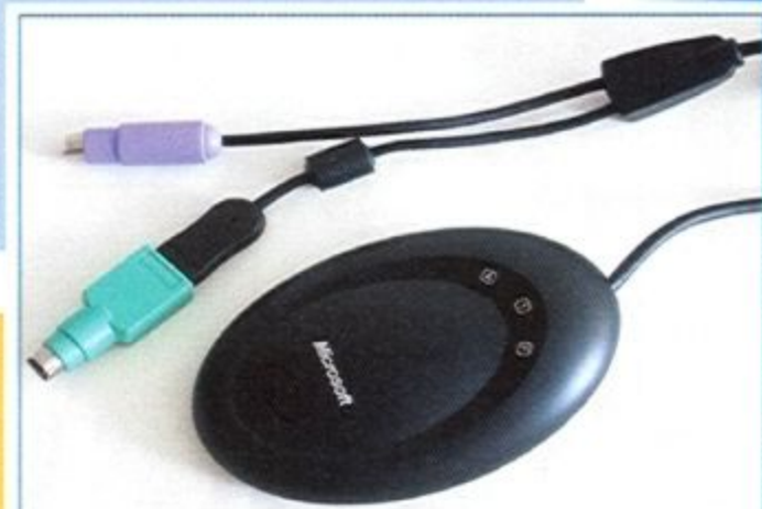
這是產品所使用的無線接收器，上面並設有鍵盤狀態指示燈。
