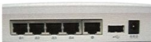
具備4x 10/100Mbps RJ-45插槽、寬頻連接RJ-45插槽、USB 1.1印表機插槽與電源插槽等。
