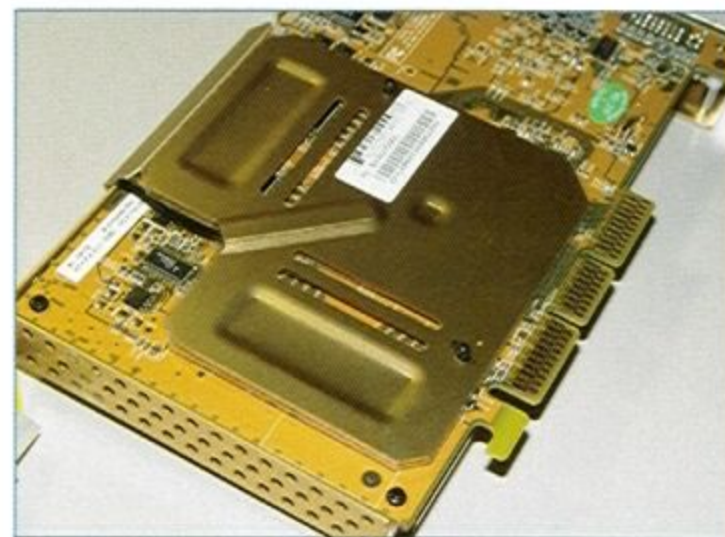
顯示卡背面也用散熱片覆蓋住顯示記憶體。
