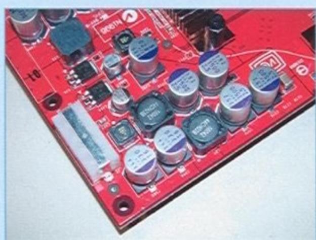
紮實的電容設計，而且要輸入4Pin的大型電源接頭
