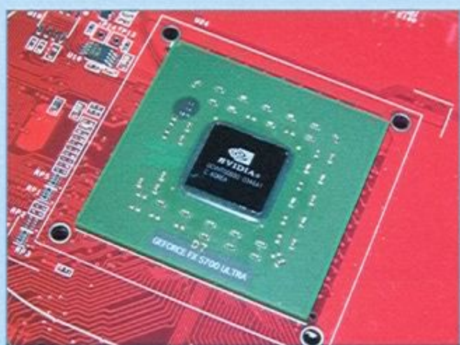
採用nVIDIA Geforce4 FX5700 Ultra顯示晶片，時脈高達475MHz。
