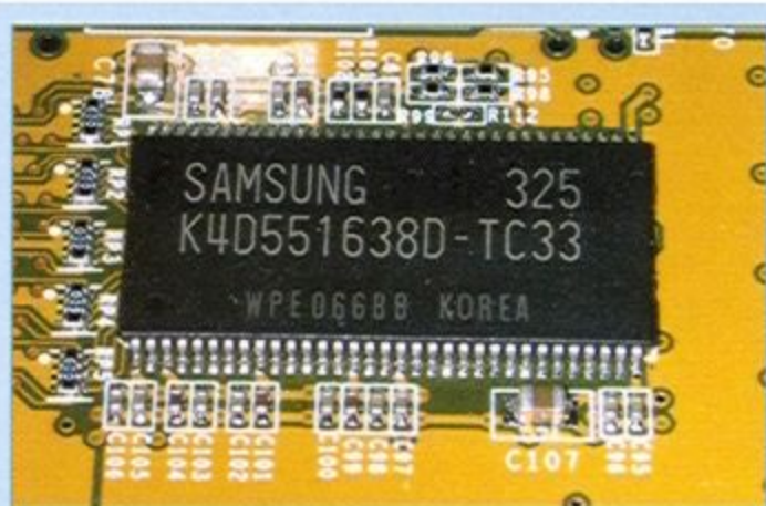
整個散熱片拆除後，可以看到顯示記憶體顆粒為 SAMSUNG K4D551638D-TC33。
