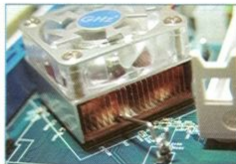
PX865PE Pro II 北橋晶片上所採用的散熱器為銅鱗片設計，可以更快的將溫度帶離。
