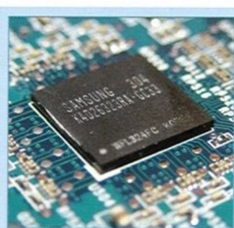
採用三星 SAMSUNG 記憶體顆粒，編號為 K4D26323RA-GC33，共提供 128MB DDR 顯示記憶體的容量。
