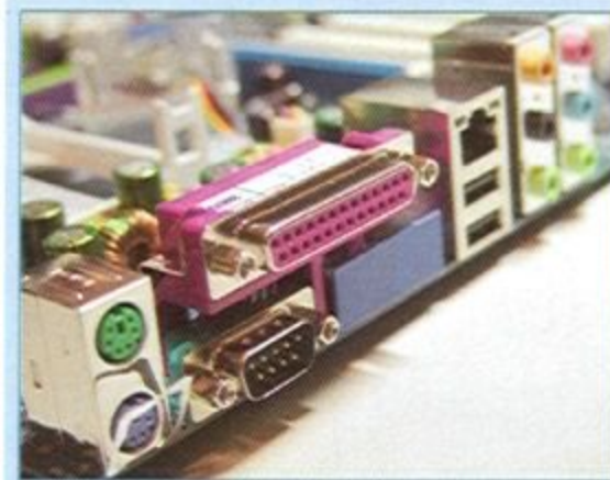
Albatron PX865PE Pro II 提供了 PS/2 鍵盤介面、PS/2 滑鼠介面、Midi/Game 介面、RJ45 介面、2 個 USB 2.0 介面、兩組 Line-out/Mic-In/Line-In 介面以及一組的 Com Port。
