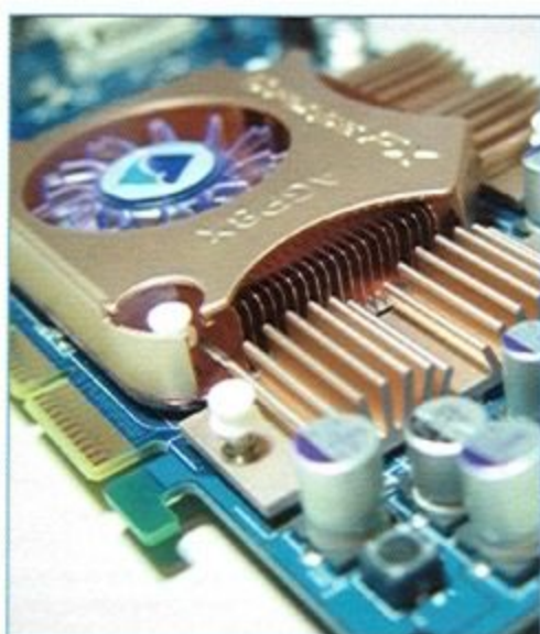
散熱器採用銅製熱器，且於記憶體上方均加裝散熱片。
