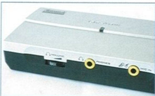
麥克風輸入 (右)、耳機插孔 (中) 與耳機音量旋鈕 (左) 是位於前面板上，如此一來，就可以很方便地來使用。
