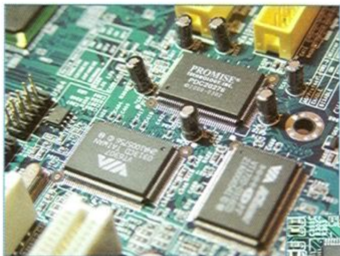
使用 Promise DC20276 提供 RAID 的功能，以及 Winbond W83627HF-AW 晶片。
