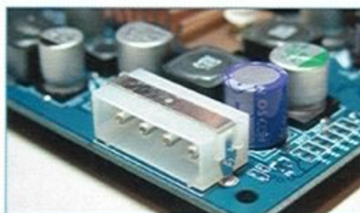
Albatron Geforce FX5600P Turbo 需要外接一個大 4Pin 電源供應，以提供順暢的電力支援。
