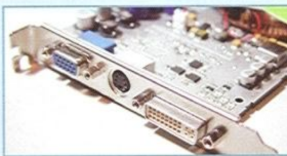
顯示卡背後提供傳統15Pin D-Sub螢幕接頭與DVI數位式接頭，還有一組多媒體VIVO專用的9Pin 連接頭。
