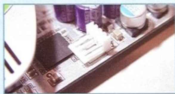
顯示卡本身具備一個4Pin 電源輸入的接頭
