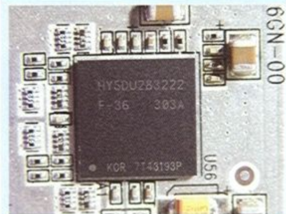
採用前後各四顆的高速Hynix 的3.6ns DDR 記憶體顆粒，共提供128MB DDR 顯示記憶體的容量。
