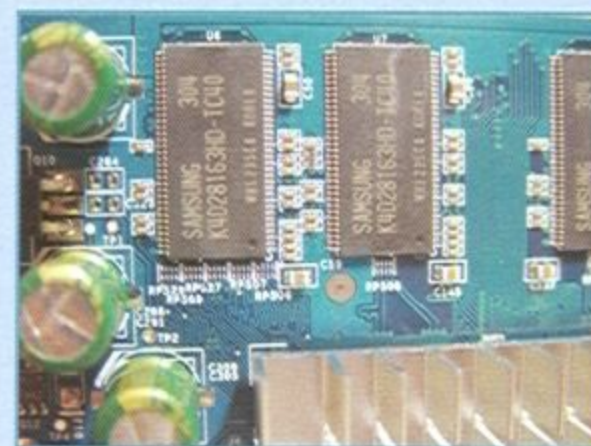
採用三星 SAMSUNG 記憶體顆粒，編號為 K4D28163HD-TC40，共提供 128MB DDR 顯示記憶體的容量。
