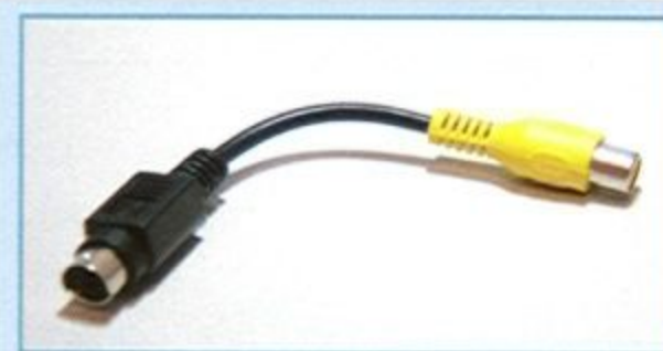
產品盒內附贈 S 端子轉 AV 線材，所以顯示卡雖然只提供 AV 端子，但是透過附贈的線材，亦可以做到 S 端子輸出的功能。
