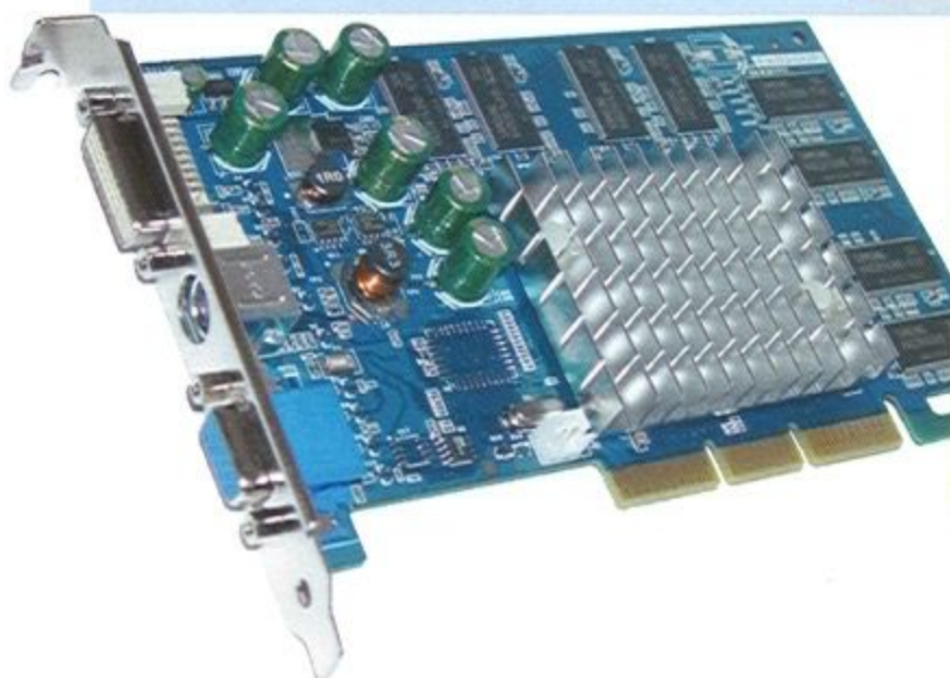
Albatron GeForceFX 5200 顯示卡為藍色 PCB 電路板製作，且並未加裝散熱風扇的設計。
