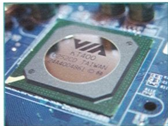
青雲 Albatron KX400-8XV Pro 北橋晶片採用了 828pin 的 BGA 封裝
