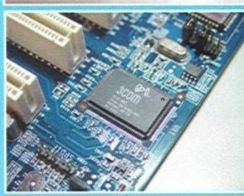
採用硬體晶片 3Com 910-A01 晶片來提供 10/100Mbps 網路介面。
