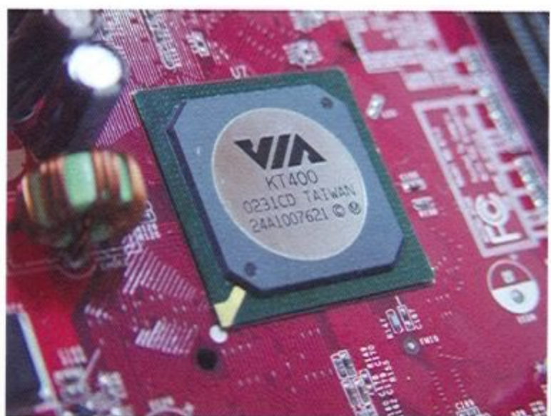
微星 MSI KT4V 北橋晶片採用了828pin的BGA封裝
