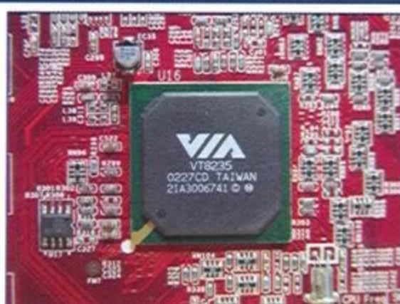
微星 MSI KT4V 採用 487pin GBA 封裝的 VT8235 南橋晶片
