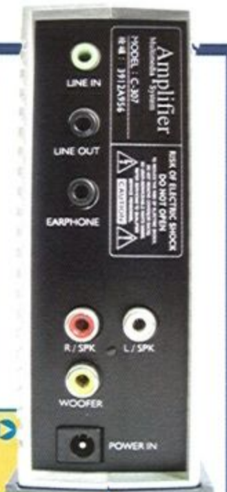
5D 擴大機背後接頭，利用顏色來區分，安裝時只需依照顏色連接即可。只提供 3.5mm 立體聲類比輸入，所以即使可以擴充為 5 件式喇叭，但僅能提供 2.1 聲道的效果。
