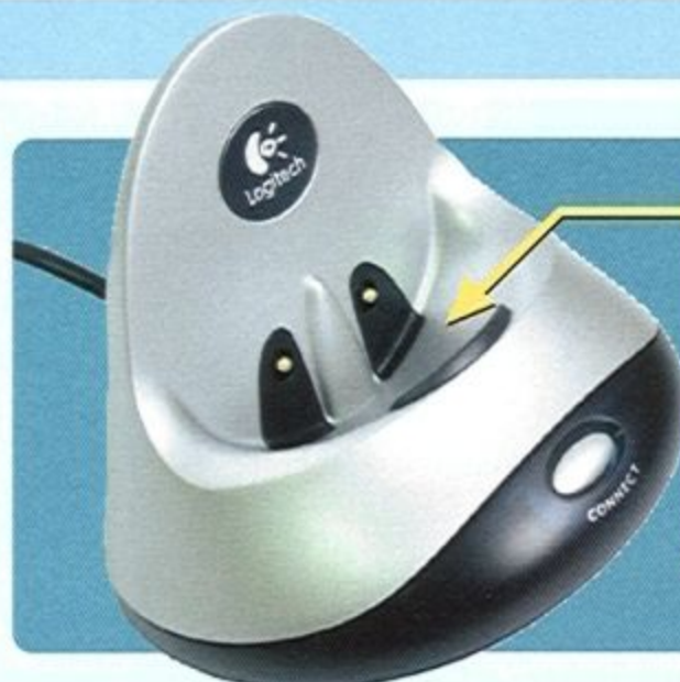
充電座的設計與無線電接收器結合在一起，外觀的設計與滑鼠的本體有相當高的完整性。
