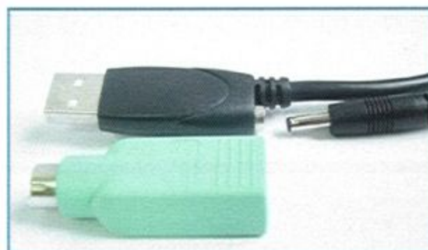
該滑鼠採用 USB 介面，廠商還貼心的附上 PS/2 轉接頭。由於具備充電功能，所以需將變壓器接頭接於 USB 的插頭處。
