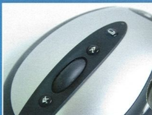
羅技獨家的巡弋工具，除了基本的按鍵功能外，還包括位於滾輪上下兩側的 Cruise Control 功能，最頂端的視窗切換功能鍵，滑鼠側面的上網頁面切換鍵等。按鍵的位置可都是精心配置，使用者可以長時間並輕易的使用這些功能鍵。
