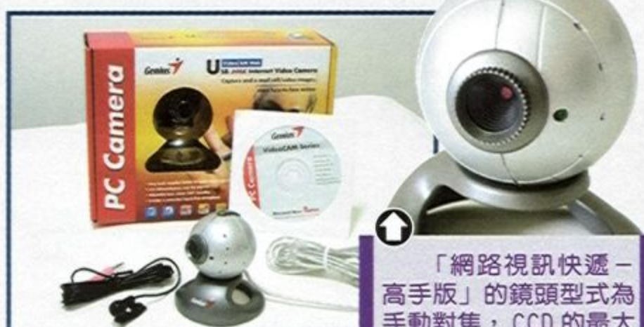
↑ 腳座的設計可讓攝影機做左右360度的旋轉以及上下仰角的調整。
