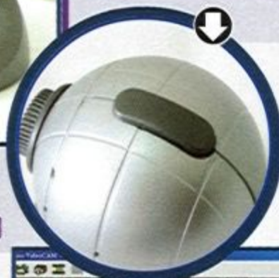
↑ 腳座的設計可讓攝影機做左右360度的旋轉以及上下仰角的調整。
