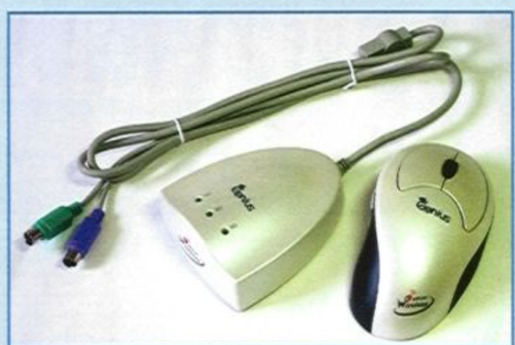
這是極光無敵手所搭載的無線電接收器與滑鼠，接收器採用PS/2接頭與電腦連接。
