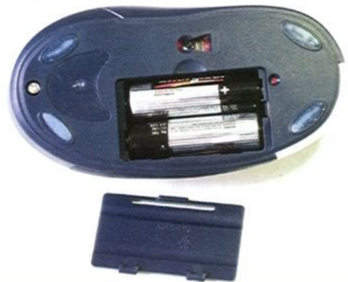
滑鼠採光學設計，底部無滾球，無需清潔的麻煩，使用時也要裝上2顆AA Size的電池。
