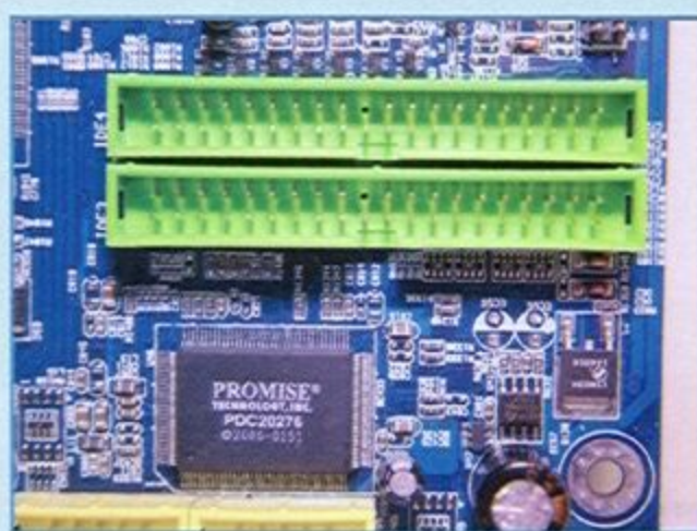
Promise 的 PDC20276 晶片，支援 ATA-133 的 IDE RAID 磁碟陣列功能
