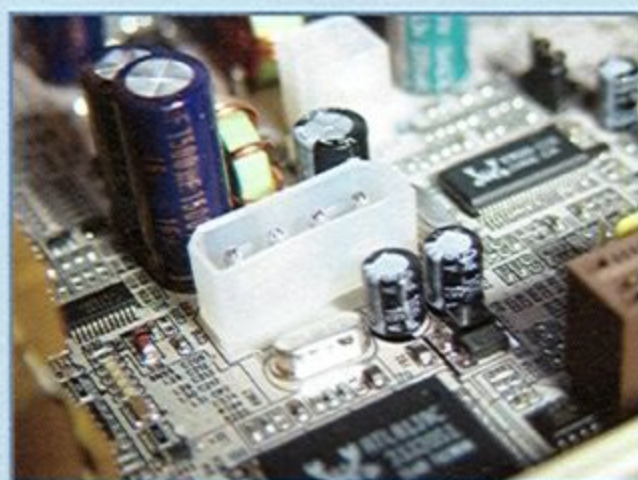
AGP 插槽旁多了一組電力供應安裝接頭
