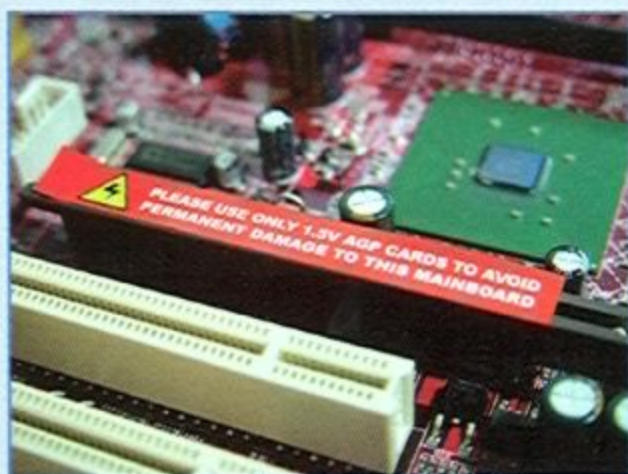
AGP 插槽上貼了警告標語，也就是僅適用 1.5V 的 AGP 顯示卡
