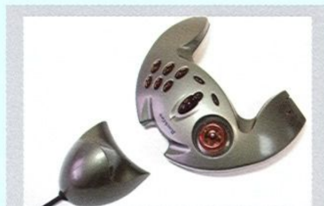
使用無線電技術所設計的無線搖桿，只利用一個接收器（左）來接收無線電訊號即可。
