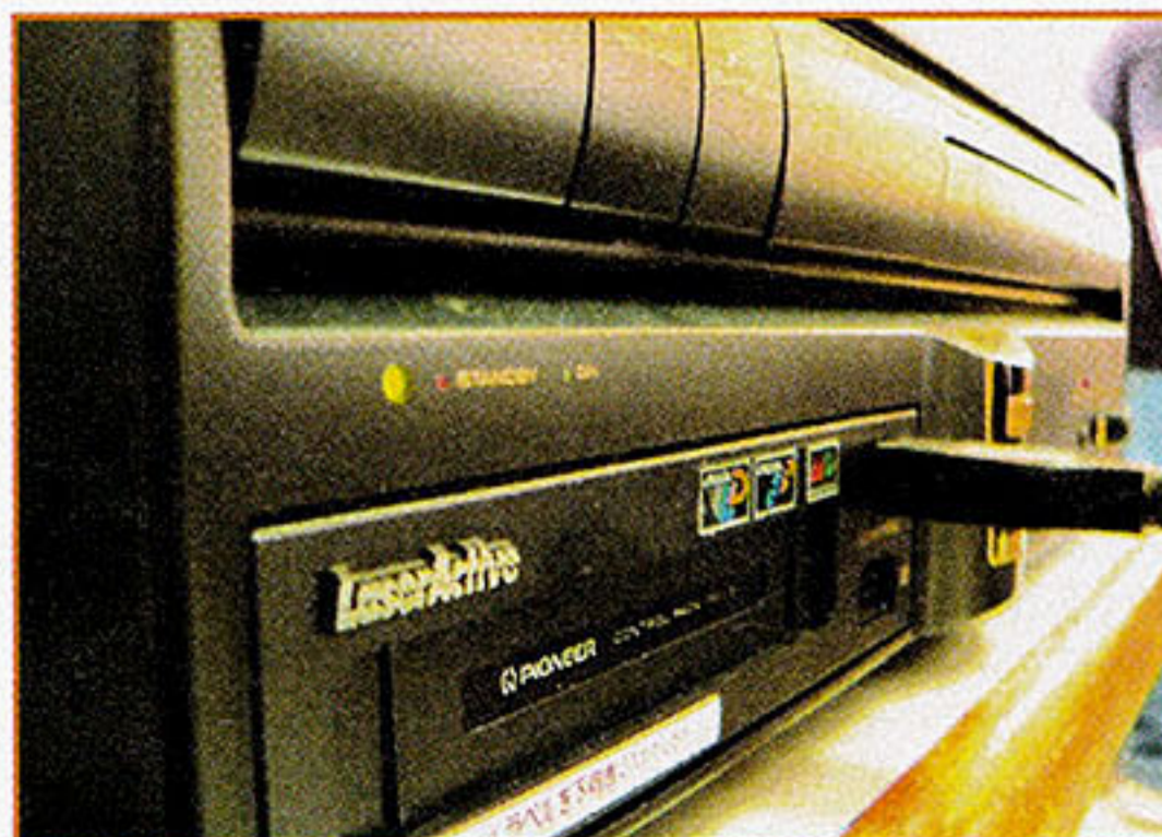
Laser Active: esse aparelho permite ao Mega Drive e PC Engine rodar jogos em LD, uma espécie de CD gigante.
