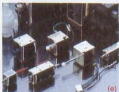
Figura 1.24 Transdutores de movimento (a) Simbologia (b) Motores AC (acima) e DC (abaixo) (c) Motor com caixa de redução (d) Motor passo a passo (e) Solenóides (f) Codificador ótico para controle de movimento
