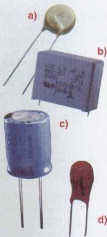
Figura 2.15. Capacitores comuns. (a) Cerâmico. (b) De película de poliéster. (c) Eletrolítico de alumínio. (d) Eletrolítico de tântalo.
