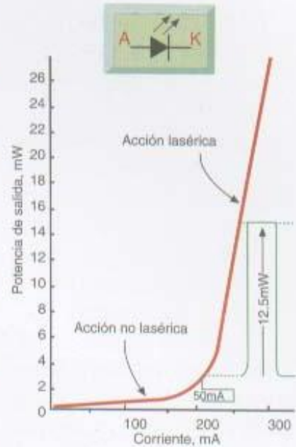
Figura 6.25 Curva característica de potência de um diodo laser
