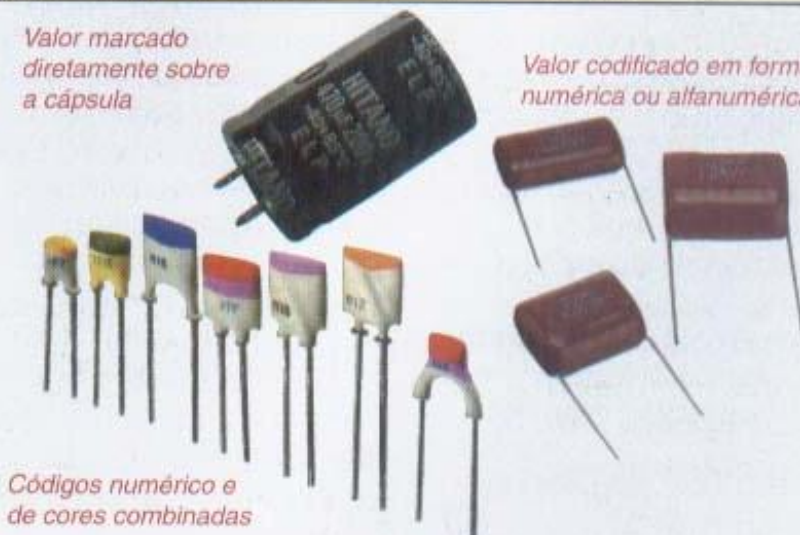
Figura 2.19 Exemplos de identificação de capacitores
