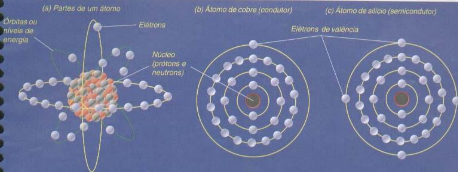
Figura 6.2 Estrutura atômica de condutores e semicondutores
