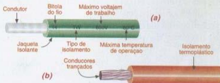
Figura 3.4 Estrutura de fios isolados comuns
