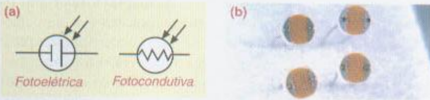
Figura 1.20 Células fotoelétricas (a) Simbologia (b) Células fotocondutivas
