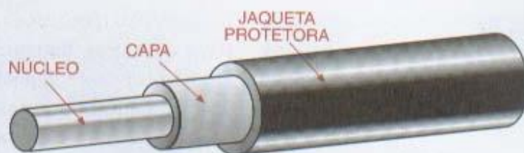
Figura 3.17 Estrutura de um cabo de fibra ótica
