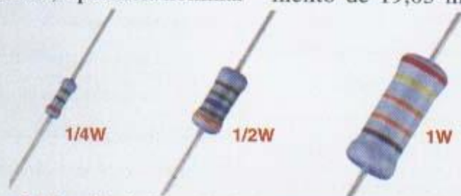
Figura 2.8 A potência das resistências está geralmente relacionada com seu tamanho físico. A fotografia mostra, por ordem, uma resistência de 1/4 W, uma de 1/2 W e uma de 1 W
