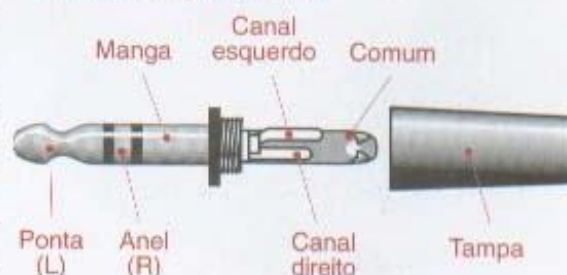
Figura 3.39 Estrutura de um plugue phono estéreo
