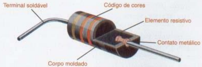
Figura 2.5 Construção interna de uma resistência de carvão
