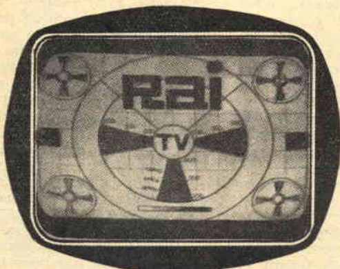
Fig. E. — IMMAGINE COMPRESSA VERTICALMENTE. - Inconveniente dovuto alla non razionale regolazione del comando altezza quadro . Al fine di ristabilire sullo schermo l'apparire dell'immagine perfetta, cioè riempire totalmente il quadro e arrotondare i cerchi del monoscopio, agiremo sul comando altezza quadro (Fig. 50 - n. 4).
