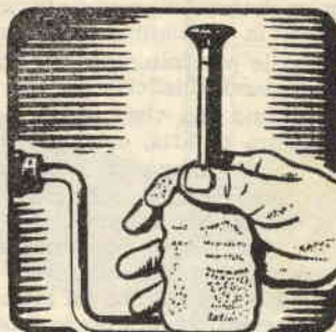
Fig. 7-8. — Il rullo in azione. Come si nota la operazione sarà condotta a spire affiancate prima in senso verticale e quindi in quello orizzontale.
