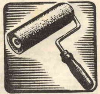
Fig. 1. — Rullo per tinteggiatura, completo di rivestimento e impugnatura.
