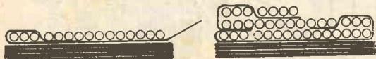
Fig. 5. — Per impedire che le spire di ogni strato abbiano a svolgersi a cadere in basso, potremo fissare le spire laterali utilizzando delle semplici fettucce di tela.
