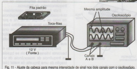
Fig. 11 - Ajuste da cabeça para mesma intensidade de sinal nos dois canais com o osciloscópio.
