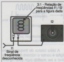
Fig. 14 - Medindo frequências com as figuras de Lissajous.
