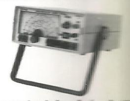
Sete escalas de frequências: A - 100 a 250 kHz, B - 250 a 650 kHz, C - 650 a 1700 kHz, D - 1,7 a 4 MHz, E - 4 a 10 MHz, F - 10 a 30 MHz, G - 30 a 120 MHz, modulação interna e externa.
