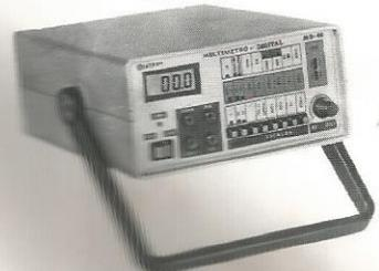
Tensão c.c. 1000 V - precisão 1%, tensão c.a. - 750 V, resistores 20 M $\Omega$ , corrente c.c./c.a. - 20 A ganho de transistores hfe, diodos. Ajuste de zero externo para medir com alta precisão valores abaixo de 20  $\Omega$ .
