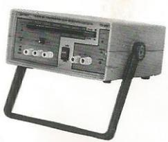
Mede transistores, FETs, TRIACs, SCRs, identifica elementos e polarização dos componentes no circuito. Mede diodos (aberto ou em curto) no circuito.
