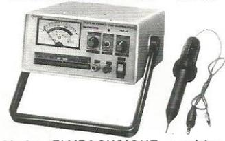
Mede FLYBACK/YOKE estático quando se tem acesso ao enrolamento. Mede FLYBACK encapsulado através de uma ponta MAT. Mede capacitores eletrolíticos no circuito e VPP.
