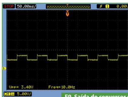
F9. Saída do conversor de frequência para 10 Hz.
