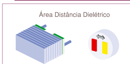
F8. Diferença fundamental entre o sensor capacitivo e o capacitor convencional.
