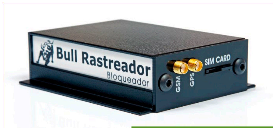
F13. Gabinete pintado e com tampas em acrílico.
