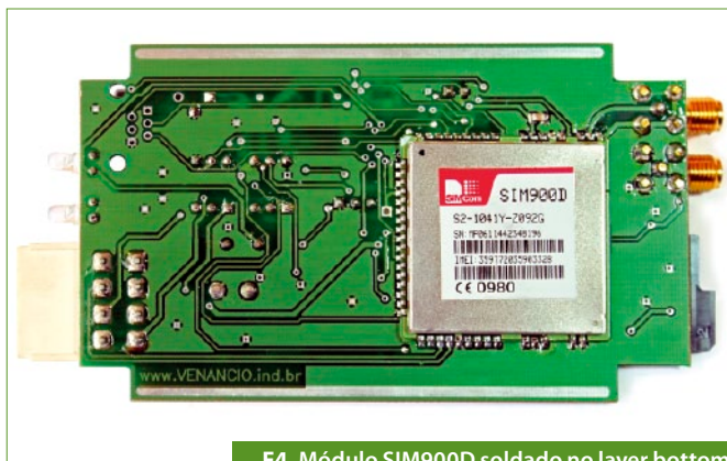
F4. Módulo SIM900D soldado no layer bottom.
